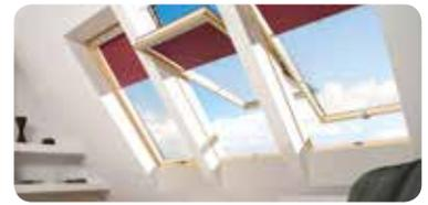
**FGP-V U3 proSky** – эксклюзивное окно для крыши с высотой до 206 см, обеспечивающее широкий обзор и дополнительное освещение. Приподнятая ось поворота створки позволяет за счет высоты окна увеличить полезную площадь остекления, и при этом устанавливать данные окна в кровле со стандартным межстропильным шагом, не требуя трудоемких работ по его изменению. Створка фиксируется под углом 160°.
